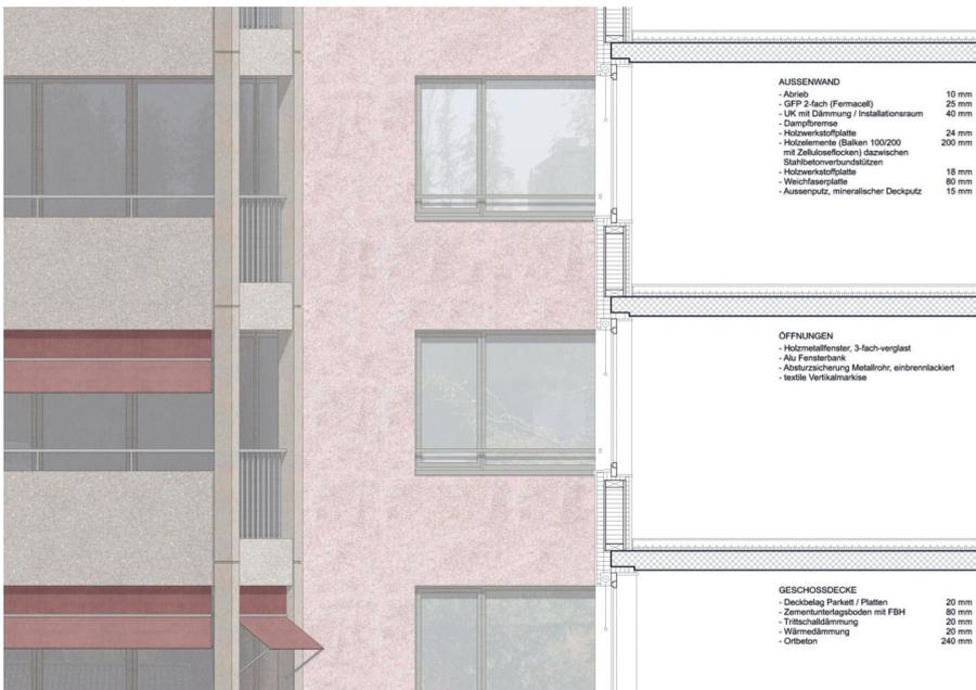
Detail Fassadenansicht und -schnitt
